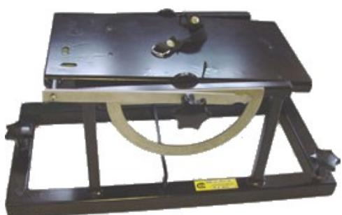
Kalibraci decelerometru lze ověřit pomocí tzv. **kalibračního stolku**. Nakláněním o předem stanovený úhel získáváme rozkladem těhové síly různé hodnoty síly, které využíváme ke kalibraci decelerometru.
