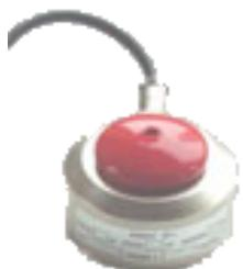
K decelerometru lze připojit čidlo síly , pedometr . Během měření se realizuje souběžný záznam průběhu zpomalení a ovládací síly na pedál během brzdění vozidla. Měřené hodnoty jsou snímány jednotlivými čidly a po spuštění záznamu ukládány do paměti. Měření zpomalení je řešeno vestavěným čidlem zpomalení, snímání ovládací síly na pedál brzdy pedometrem
