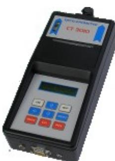
**Decelerometr CT3010** je určen pro měření průběhu a hodnoty plného brzdného zpomalení vozidel jízdní soupravy v závislosti na ovládací síle na pedál brzdy nebo na tlaku vzduchu ve vzduchotlakové brzdové soustavě a jejich dokumentování grafickým záznamem s numerickým výpočtem plného středního zpomalení, střední ovládací síly nebo středního tlaku.
